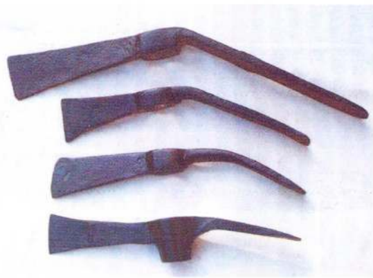
Magalls (el que està a sota, amb la ullera molt més gran, és un pic modificat). Se'n feien de diferents mides, en funció del tipus de feina i de la força del bosquerol.
