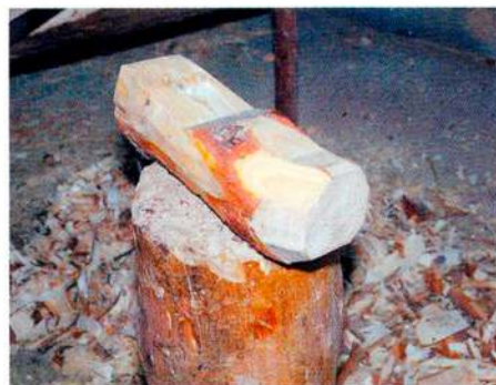
Esclop acabat de conformar amb l'aixol.
