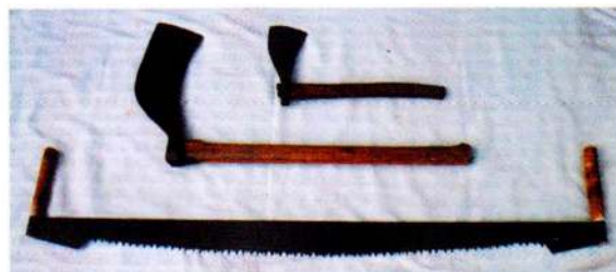
Destrals xica i grossa i xerrac de dues mans. Així com les destrals les feien també els ferrers dels pobles, els xerracs els fabricaven empreses especialitzades.
