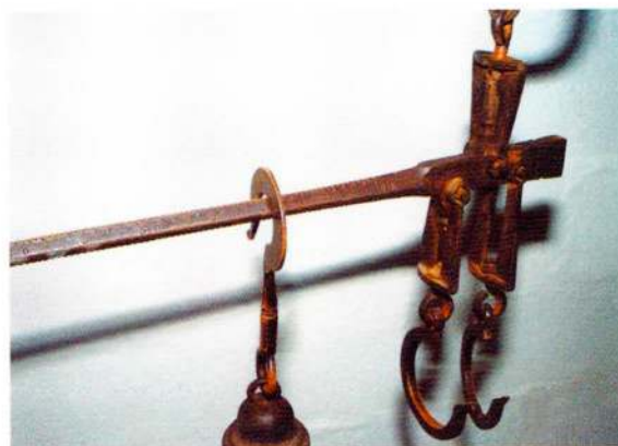
Detall d'una romana. Es penjava d'una branca o d'un pal aguantat per dos homes. Girant-la, permetia ampliar el marge de pesada.
