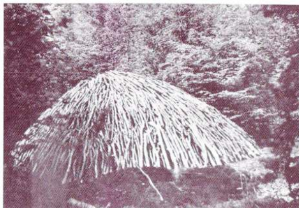
Pila carbonera feta amb faig, abans de ser embalumada; al davant es veu el fagell. Santa Fe del Montseny, data i autor desconeguts.
