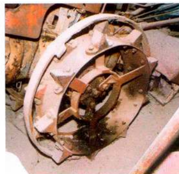
Roda d'un motocultor Condor, fabricat a Barcelona els anys 40-50 del s. XX. El dentat és de l'estil dels que duïen els primers tractors. Col·lecció A. Torras. Santpedor, 2006
