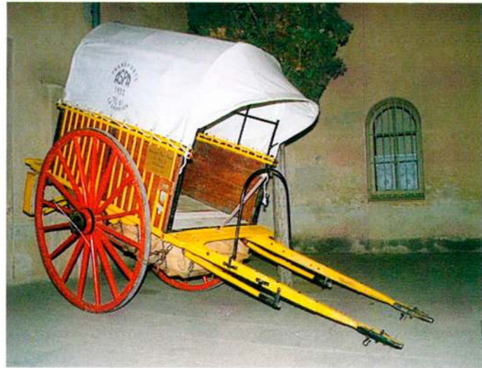
Carro d'escala amb vela. S'observa el capçalet anterior i, una mica més endavant, la barra corbada de protecció de la cavalleria, que va de braç a braç; per sota d'aquests, els descansos; la roda porta el fre i també està fixada per davant; no hi ha bosses sinó una plataforma de càrrega. La Garriga, 2004.
