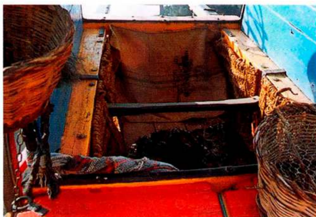
Interior d'un carro d'escala, vist pel darrere. Al mig, el fusell i les bosses; a cada costat, els bancs; en primer terme, part del capçalet posterior. La Garriga, 2004.
