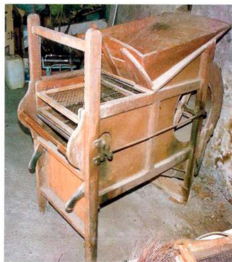
Ventadora fabricada per la casa Múgica y Arellano, de Pamplona. La barra horitzontal del davant fa moure els garbells; la maneta i els engranatges queden al darrere.
