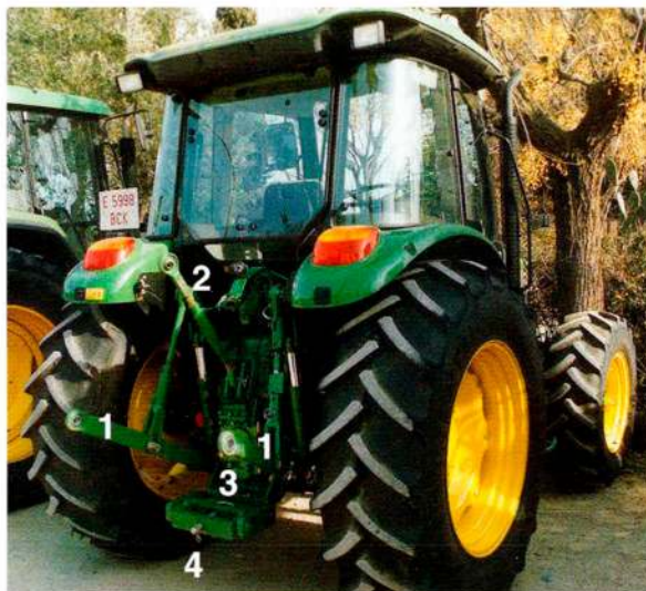
Principals elements de treball d'un tractor actual. 1: alçament hidràulic; 2: tercer punt de fixació; 3 presa de força (parcialment tapada); 4: barra de tir. Llerona, 2004.
