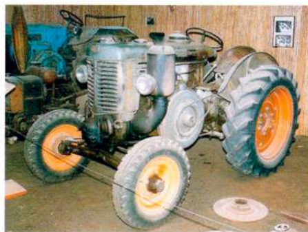
Tractor Landini, italià, una de les marques destacades que van treballar en la comarca (juntament amb els Lanz, Fordson, etc..) en els primers temps. S'observa la politja, al centre. L'exemplar es fabricà a l'entorn de 1945. Col·lecció A. Torras. Santpedor, 2006
