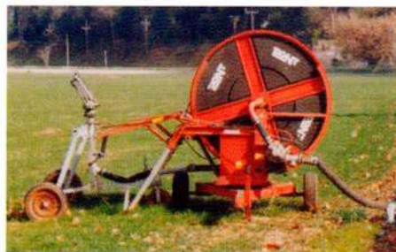
Trac. A l'esquerra s'observa l'aspersor; a la dreta, la presa d'aigua.
