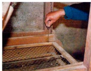
Garbells d'una ventadora (n'hi anaven dos, sobreposats), amb el passador de fixació
